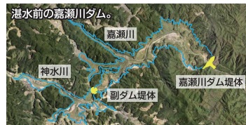
青線はサーチャージ水位時の水際線を示します。嘉瀬川ダムにはダム湖内に副ダムがあります。
