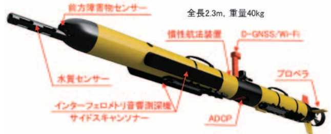
図-4 AUV外観と各種機能（提供：EJEC）
