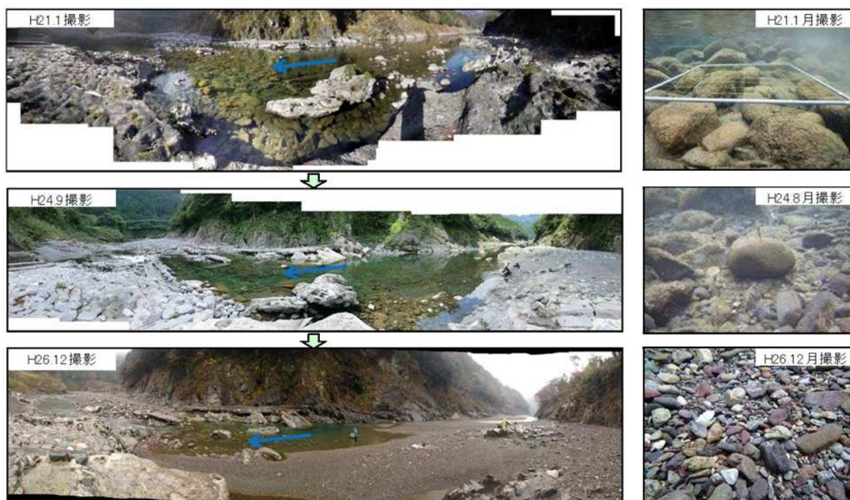
図 5-9 長安ロダム下流の河川景観と河床材料の経年変化：小計橋（60.3～60.5k）
