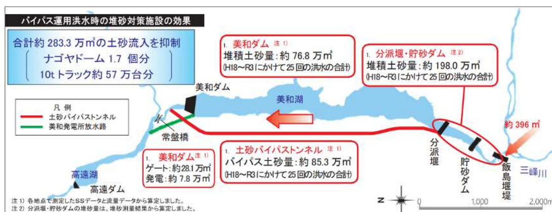
図 4-10 美和ダムのバイパスを含む堆砂対策施設の設置効果
